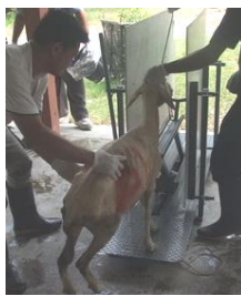
ภาพที่ 2 แท่นเชือดแพะแกะ แบบไม่ต้องใช้การผูกมัดตัวสัตว์
